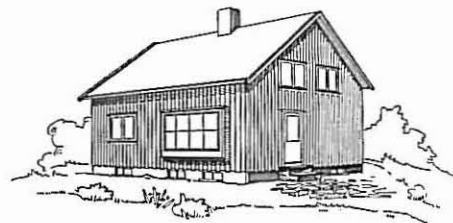
Fig. 2. Enebolig i 1½ etasje med brutto grunnflate 60 m 2 , brutto boligflate 116 m 2 og brutto boligvolum 285 m 3 . Boligdirektoratets typehus nr. 225.
