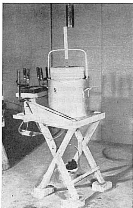
Fig. 4. Apparatur for måling av lufttetthet av byggematerialer. Forsøkene utføres ved Norges byggforskningsinstituttets laboratorium i Trondheim.
