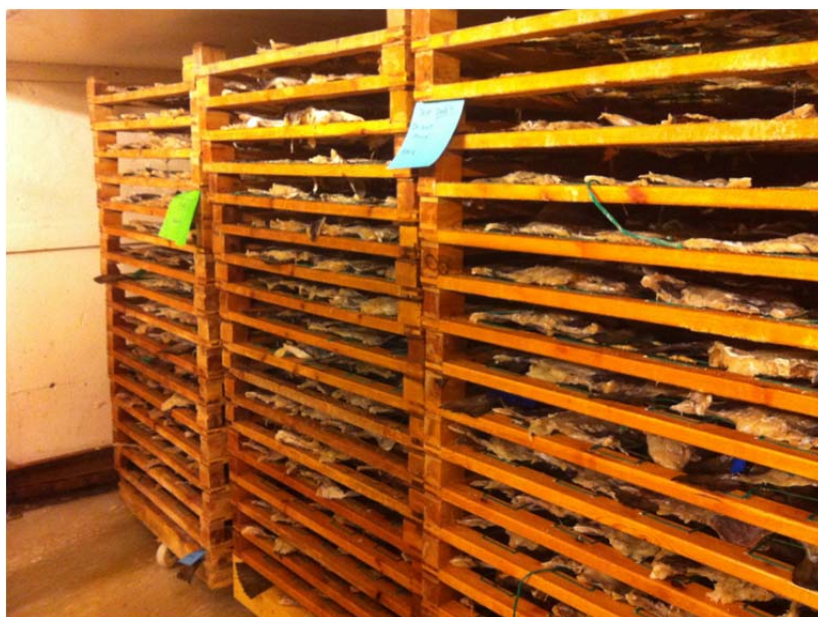
Figur 4: God nok plass mellom brettene, moderat rom for falskluft over og under vognene, men en utfordring med støttebjelker på sidene som tar plass av tverrsnittet.
