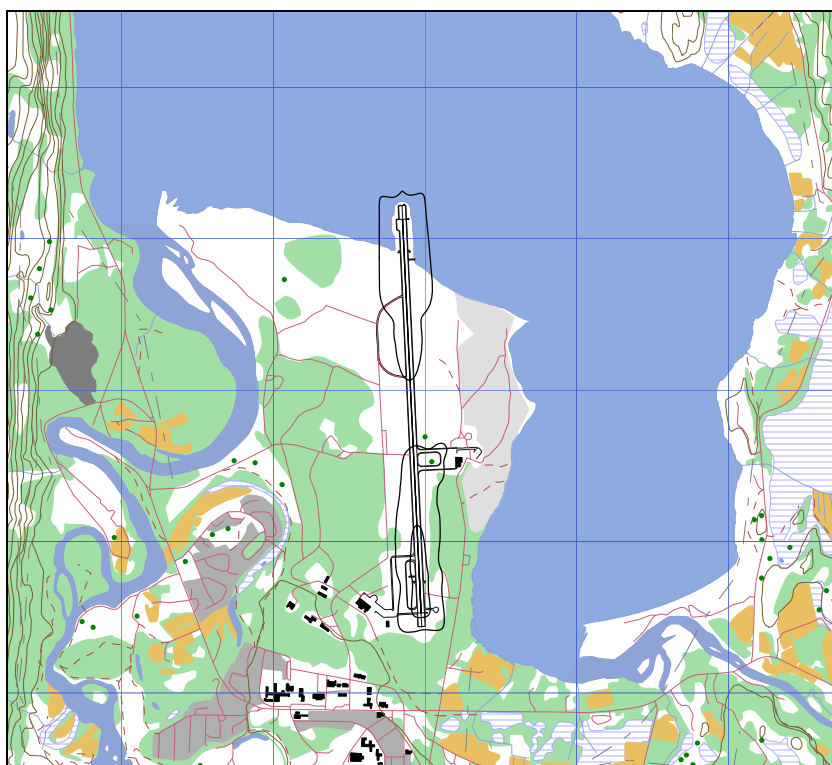
Figur 10-5 Maksimumsnivå på natt for dagens situasjon, total trafikk. Kotene viser L_{5AS} på 80 og 90 dBA. M 1:50 000.
