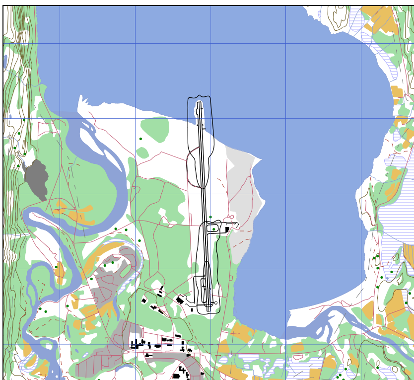
Figur 10-10 Maksimumsnivå på natt for 10 års prognosen, total trafikk. Kotene viser L_{5AS} på 80 og 90 dBA. M 1:50 000.
