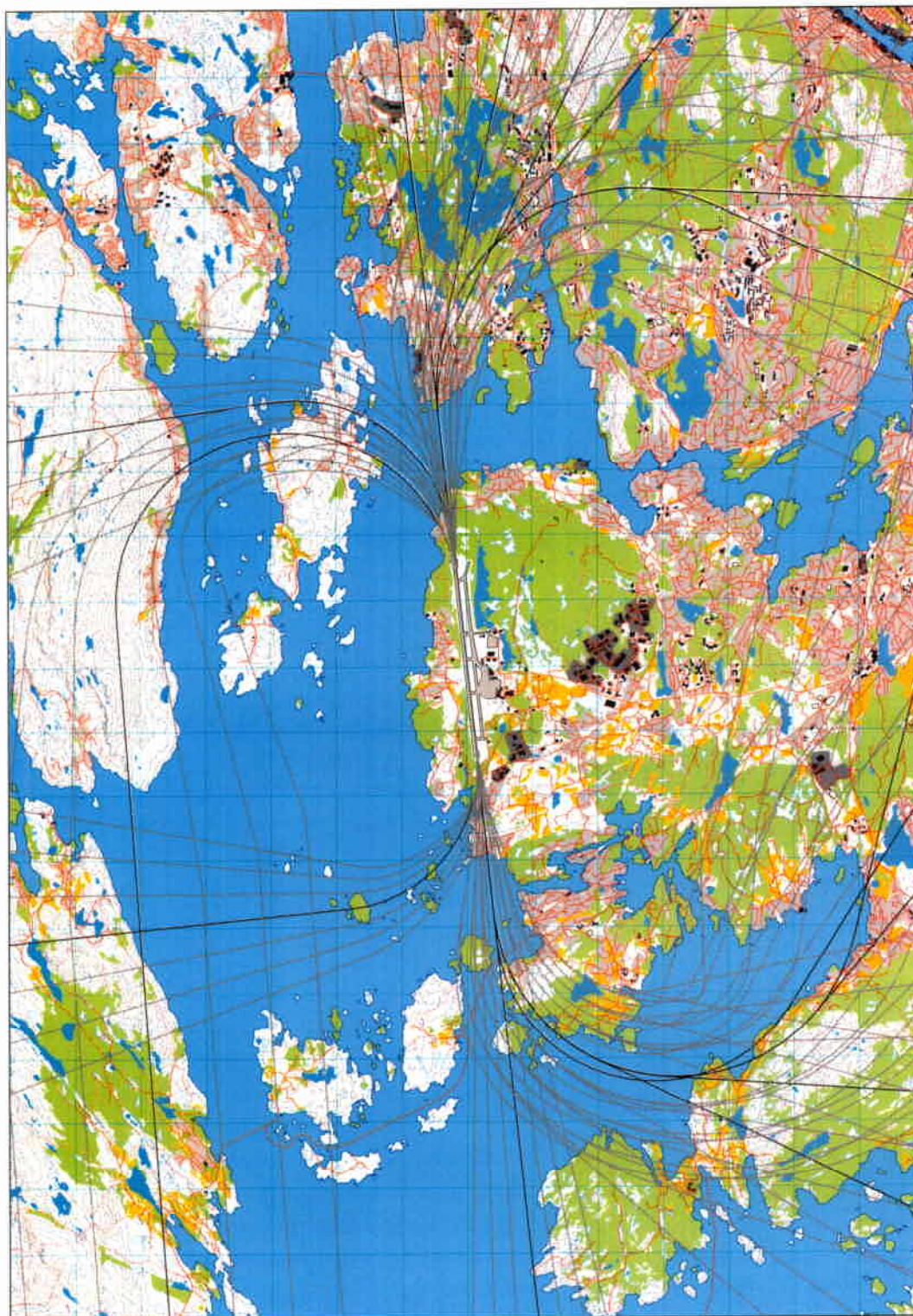
Figur 6-1 Avgangstraséer med spredning for jetfly. Målestokk 1:100 000.
