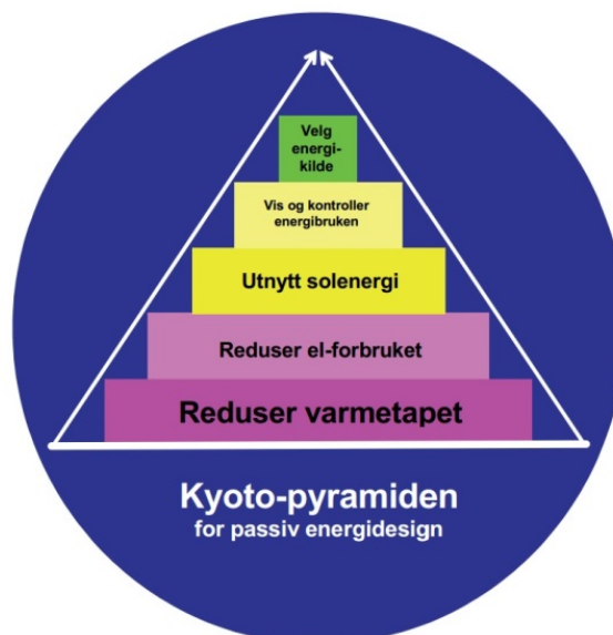
Figur 4.2 Kyoto-pyramiden, basert på prinsippet om at «den mest miljøvennlige energien er den vi ikke bruker». Kilde: Husbanken/SINTEF Byggforsk.
