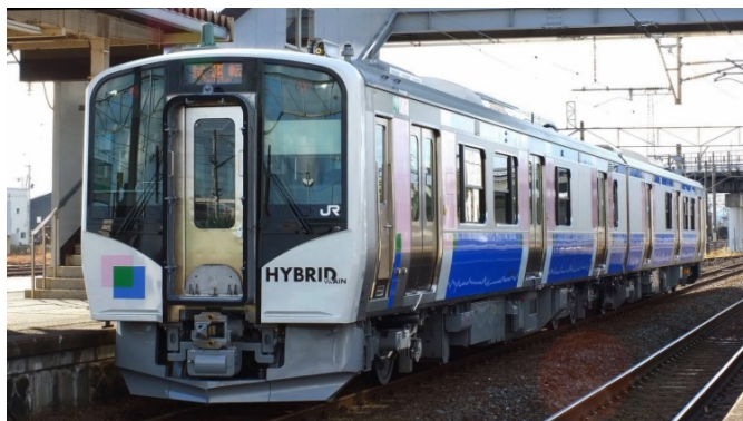
Figur 36: Japan Rail (JR) Freight's dieselhybrid benytter Li-ion-basert batteriteknologi (til venstre). Denne, samt JR-persontog også som dieselhybrid, ble satt i drift i 2010 og nytt materiell i 2015 (til høyre).
