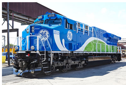
Figur 15: Naturgassdrevet tog i Alberta, Canada (til venstre). General Electrics ombygde diesellokomotiv til naturgass (til høyre).
