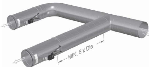
Figur 4 For kort avstand mellom avgrening og VAV-spjeld gjør at VAV-spjeldet måler gal luftmengde.
