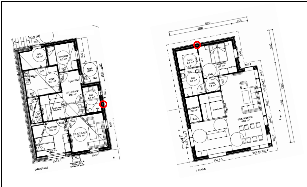
Figur 20: Røde sirkler angir plassering av trefuktloggere i veggene.
