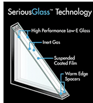
Foto og illustrasjoner: Ved rehabiliteringen av Empire State building ble de gamle vinduene omformet til moderne vinduer på selve byggeplassen (Greenbiz 2010).
