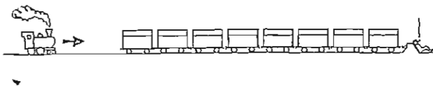
Fig. 3. Hver godsvogn på sidesporet representerer et luftmolekyl som ligger i ro. Løsløkomotivet støter mot vognrekken; det er lydkilden som setter første luftmolekyl i bevegelse. Vognene rykker frem og tilbake; det blir avvekslende trykk på buffertene og strekk i koblingene, altså avvekslende luftfortetning og luftfortynning i luftmassen. Bukken i enden av sporet representerer rommets skillevegg; den settes i vibrasjon. Han som sitter og hviler er første luftmolekyl i rommet på den andre siden av veggen. Han merker en svak rystelse; det svarer til at luften på denne siden settes i betydelig svakere svingninger.
